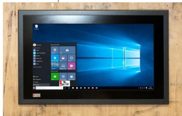
**Wandeinbau - extra schmale Gerätetiefe 43mm inklusive Einbauwanne zur Montage in der Trockenbauwand oder Mauernische.**
